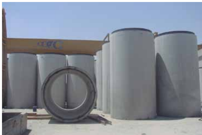
Conducción de agua - Tubería en Hormigón
