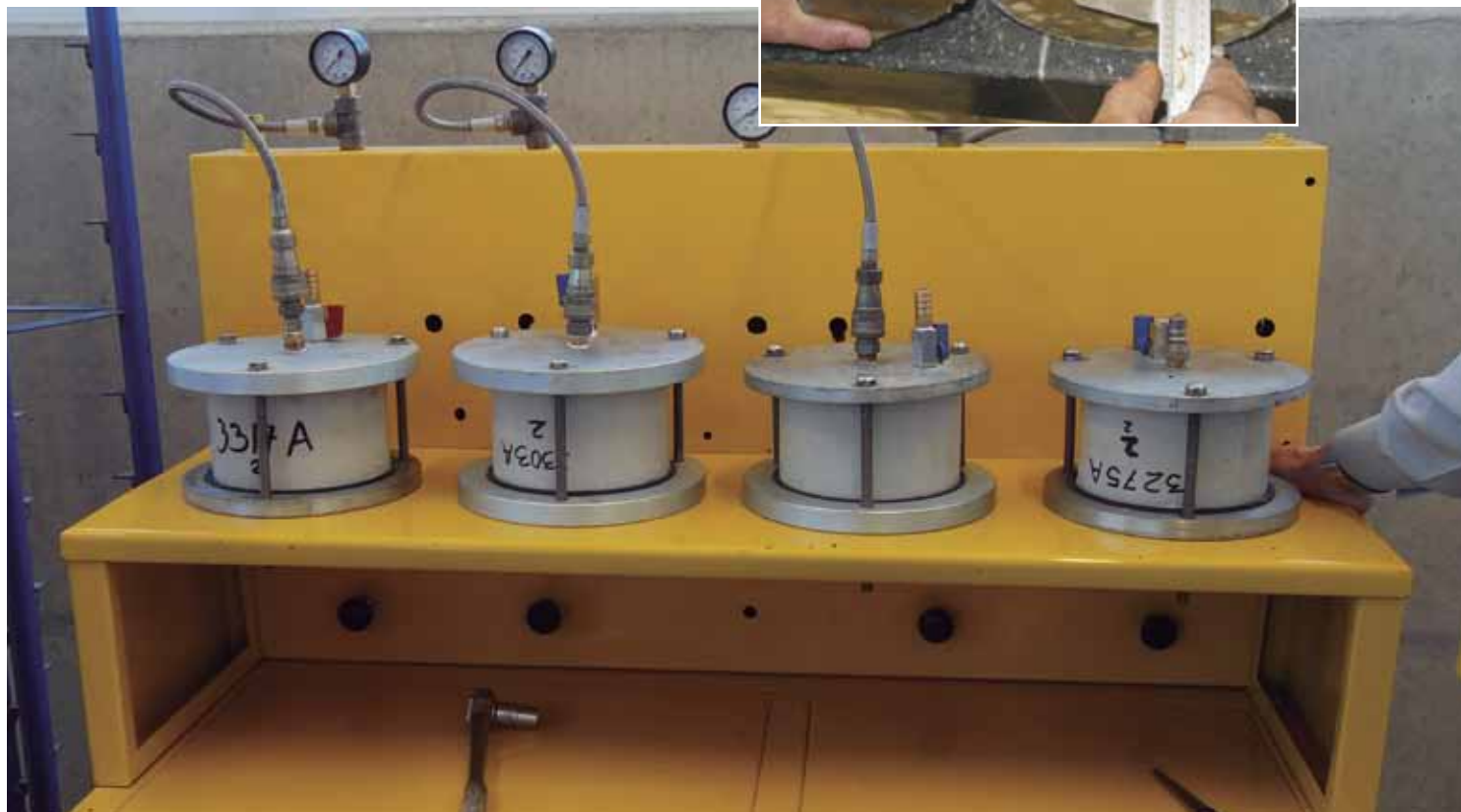
Dispositivo de medición de la permeabilidad del hormigón.
