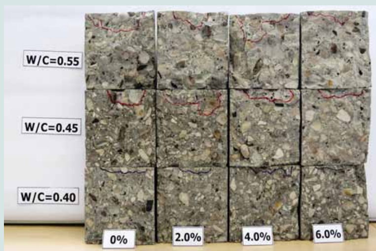
Figura 20. Efecto de Sika WT-100 sobre la penetración de agua.
