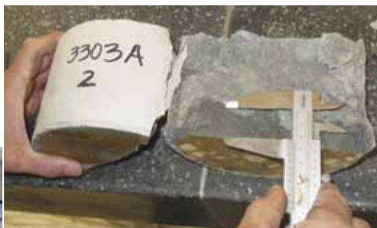
Determinación de la profundidad de penetración de agua.
